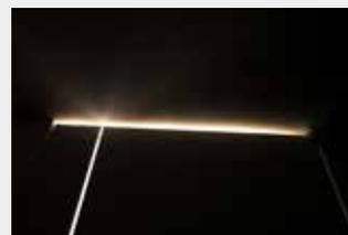
採光部材質：樹脂／スリット幅：5mm（20 ページ参照）
