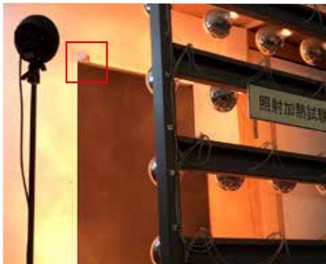
本来の照射加熱試験(5日間)ではなく、熱量を1.4倍にして3時間集中的に熱照射し、強制的に反らせる試験を実施
