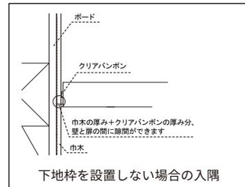
下地枠を設置しないと、壁と扉の間に巾木の厚み+クリアバンポンの厚み分隙間ができるため推奨いたしません。
