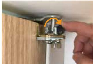
③扉を45°以上開いた状態にして上の方を持ち、ヒンジ側へ押してヒンジ軸から外す
