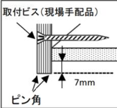
壁厚より7mmチリが出る(クロス貼り仕上の場合) | 取り付けビス(現場手配品)
