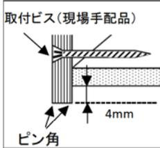
壁厚より4mmチリが出る(塗り壁仕上の場合) |                                                                                                          |  |
