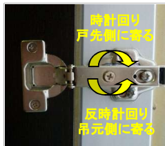
左右方向の調整 時計回り → 戸先側に寄る 反時計回り → 吊元側に寄る
