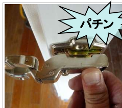
装着時の「パチン」の音を確認
