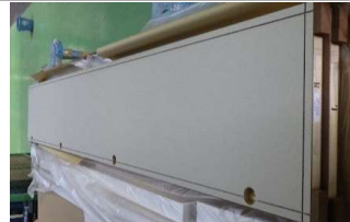
扉の裏面(化粧シート貼り) クロス見切り用の溝加工済・スライド丁番の座堀加工済
