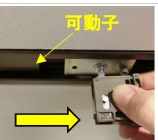
吊車金具固定ネジは完全に取り外さないように注意してください
