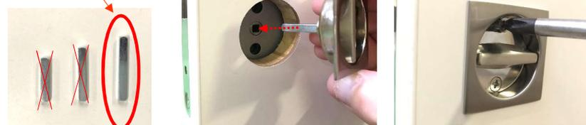
扉にアウトセット引戸錠を取り付けた後、受け金物を中方立下地の角部と扉に取り付けたアウトセット引戸錠の高さ位置に合わせ、付属ねじで固定します。
