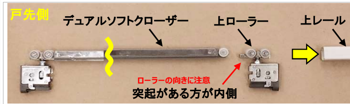
上ローラーをレールに入れる
