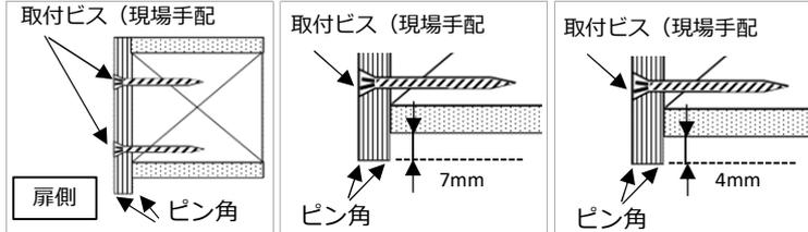
調整ビスにより枠を固定
