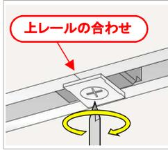
バンパーブロックを手動ドライバーにて上レールの合わせ目に固定
