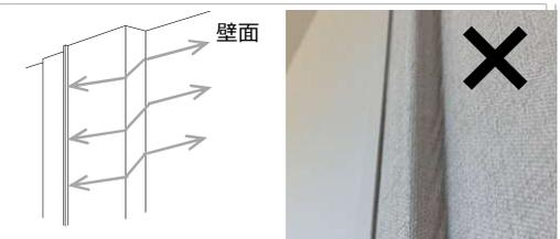
**注意** ※上枠下地のレール溝部分はクロスを貼り伸ばして、上レール溝に巻き込んでください。
