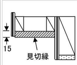
次に、戸袋側の小壁に沿わせて見切縁を接着剤・タッカー(現場手配)併用にて取り付けます。
