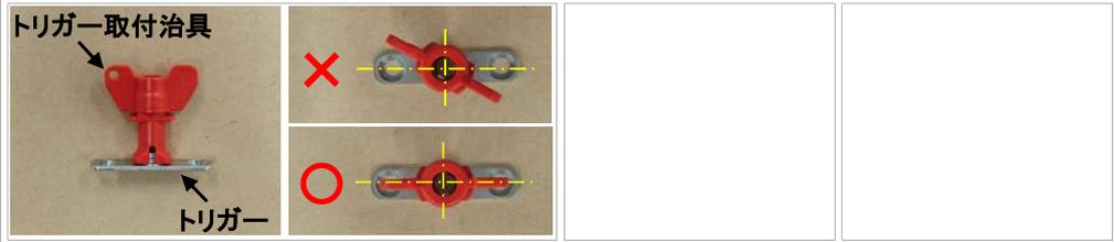
トリガーをトリガー取り付け治具にセット
