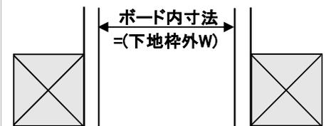
図面上のRow寸法（下地枠外W）の確認
