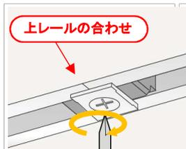
ハンパーブロックを手動ドライバーにて上レールの合わせ目に固定
