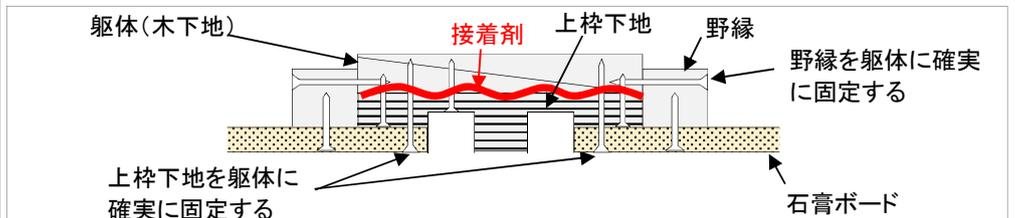
石膏ボードの厚さ分を確保して、野縁を躯体に固定
