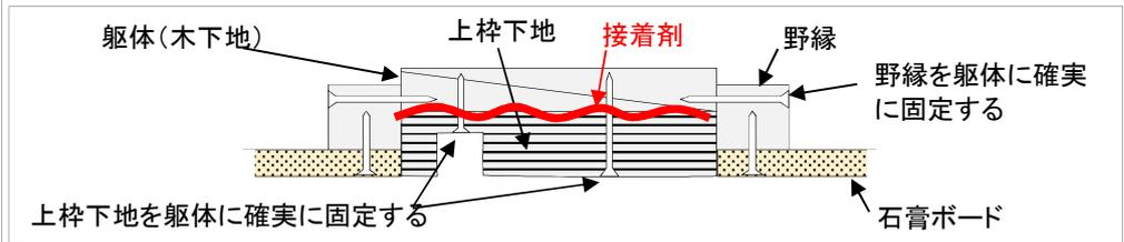
石膏ボードの厚さを確保して、野縁を躯体に固定
