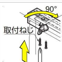
治具を90°回し、トリガーを取付ける
