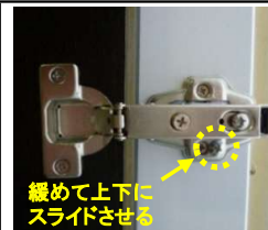
上下方向の調整 ビスを緩めて丁番を上下にスライドさせる
