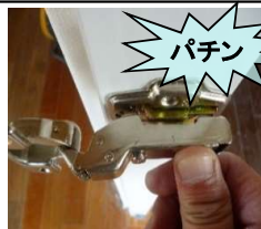
装着時の“パチン”の音を確認
