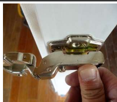
クリップ部分を座金の突起部分に押し当てる
