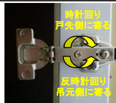
左右方向の調整 時計回し → 戸先側 反時計回し → 吊元側
