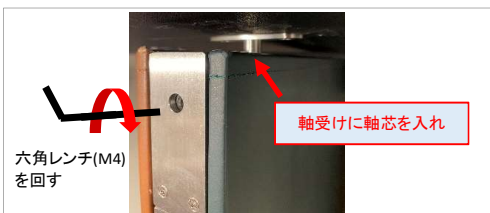
軸受けと軸芯を合わせ、調整ネジを回して軸芯を軸受けに入れる
