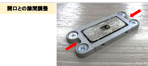
6箇所の調整ネジ (赤矢印部) を同梱の六角レンチ(M3)で「扉の閉鎖位置」と「開口との隙間」を調整
