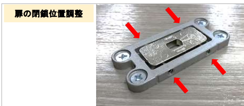
6箇所の調整ネジ (赤矢印部) を同梱の六角レンチ(M3)で「扉の閉鎖位置」と「開口との隙間」を調整
