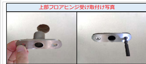
穴加工部に上部フロアヒンジ受けを同梱ビス (M5×25 半ネジ) で取付け
