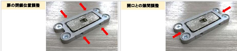
6箇所の調整ネジ（赤矢印部）を六角レンチ(3mm)で六角レンチサイズ(2面幅)「扉の閉鎖位置」と「開口との隙間」を調整
