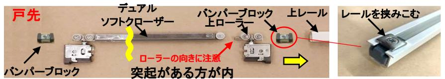
【アウトセット片引き戸エンド枠付き】 レール長さ = 上枠下地長さ - 24mm
