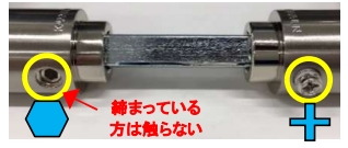
芯棒がついている側の六角ネジは外さない 両側から押し付けながら手動+ドライバーでネジ締め
